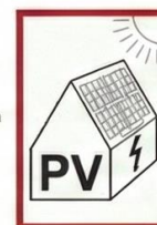
Abbildung 36: Hinweisschild zum Vorhandensein einer PV-Anlage ohne auch mit Speicher
